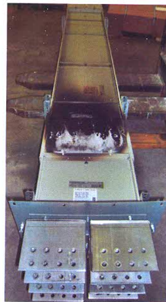
Particolare della zona danneggiata del campione dopo la prova.
